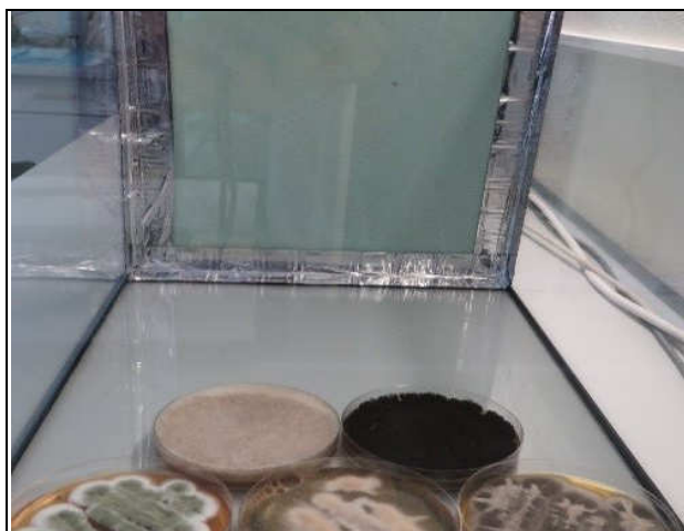
Abb. 5: Zwischen Schwarz- und Weißbereich wurden die zu untersuchenden Baustoffe eingebaut, hier Feuchtraumpaneele
