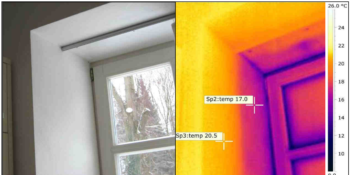
Abb. 25 + 26: Auswirkung von Vorhängen auf die Oberflächentemperatur im Bereich der Fensterleibung
