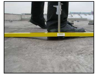
Verformungsmessung bei typischer Belastung
