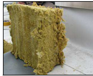
Probe mit stark verminderter Druckbelastbarkeit
