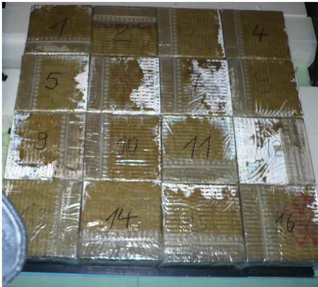
Abbildung 5: Anordnung der Mineralwollequader auf der unteren Temperierplatte
