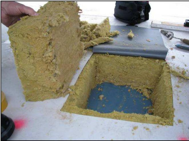
Abbildung 23: Probe Nr. 1 mit hoher Druckbelastbarkeit
