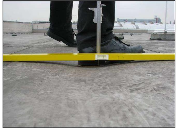
Abbildung 6 und 7: An besonders weichen Stellen wurden Verformungsmessungen mit Hilfe einer Hartfaserplatte und einem Rechteckrohr (Wasserwaage) durchgeführt. Rechts eine relativ große Verformungstiefe von ca. 33 mm.
