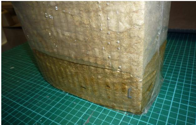
Abbildung 4: Mineralwollequader mit definiertem Wassergehalt in Kunststoffolie verpackt
