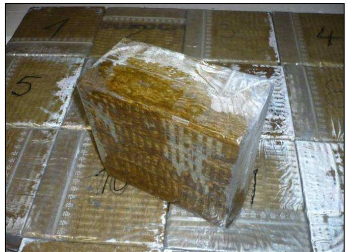
Abbildung 47: Für die Temperaturwechsellagerung vorbereitete Proben
