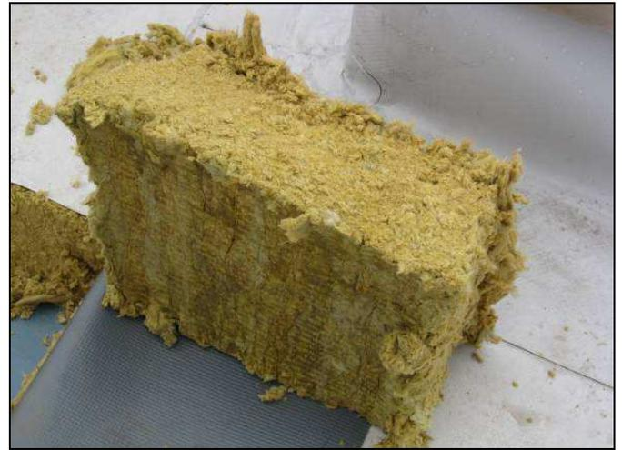
Abbildung 24: Probe Nr. 5 mit stark verminderter Druckbelastbarkeit
